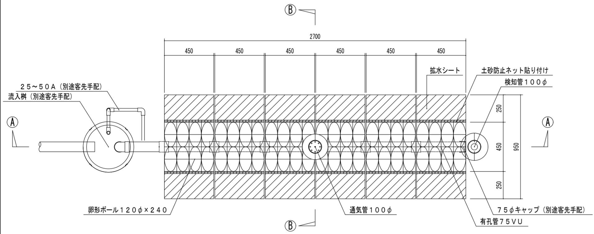
SRS-eps土壤拡散処理システム平面図
