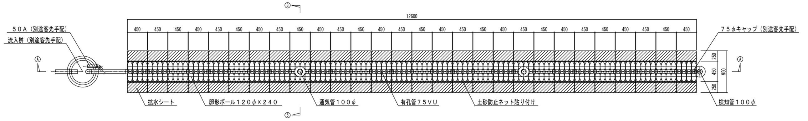
SRS-EPS 土壌拡散処理システム平面図
