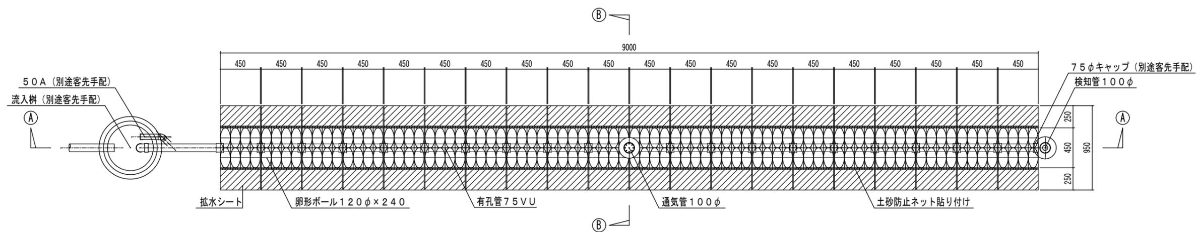
SRS-EPS土壌拡散処理システム平面図
