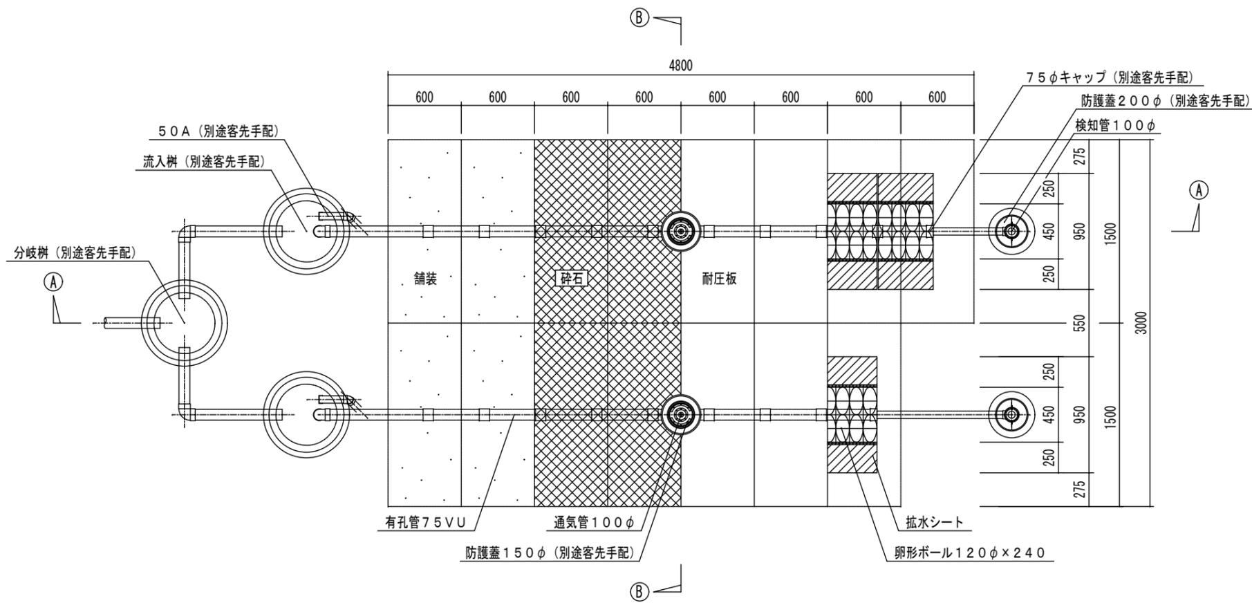
SRS-EP S土壤拡散処理システム平面図
