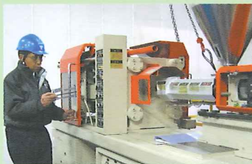
テストピースの成形。(JIS規格)
