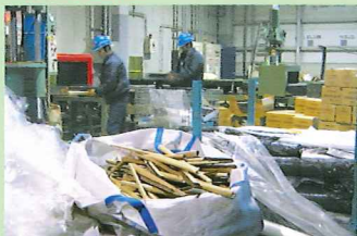
素材〜材質分別し、品質安定を計ります。
